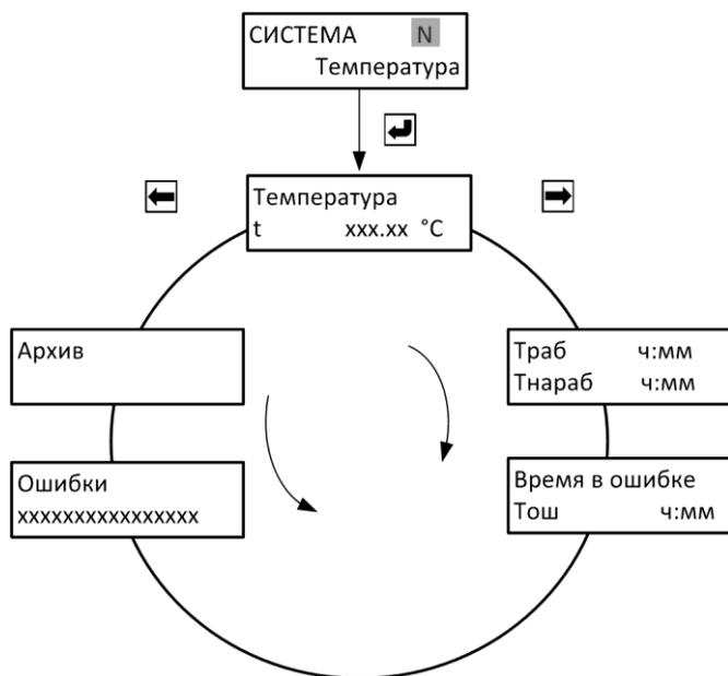
Рис. Г.1 Схема меню режима «Рабочий» для схемы учета «Температура»
